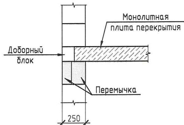
Устройство перемычек в стенах различной толщины
