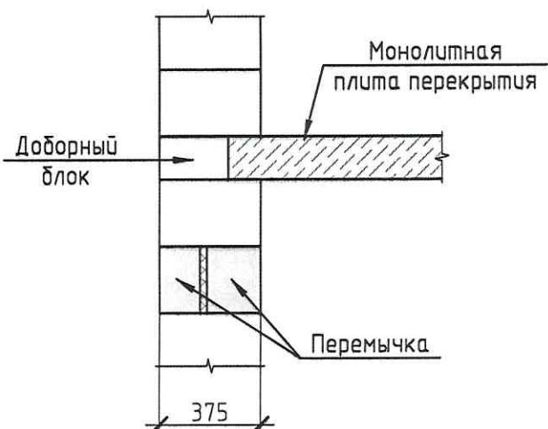
Устройство перемычек в стенах различной толщины
