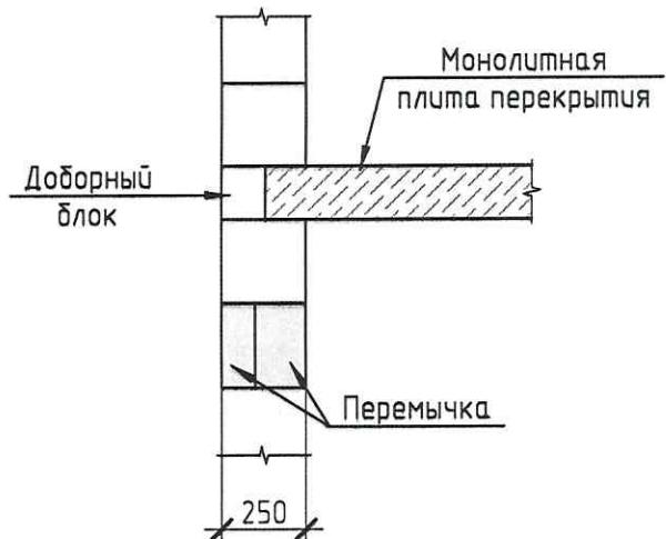
Устройство перемычек в стенах различной толщины
