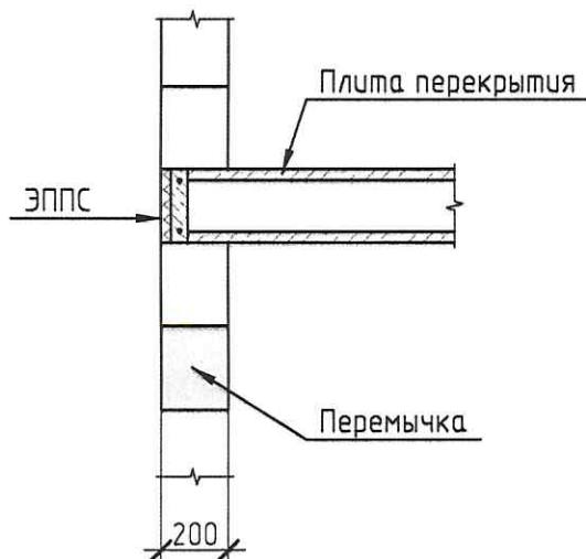
Для стен толщиной 250 мм
