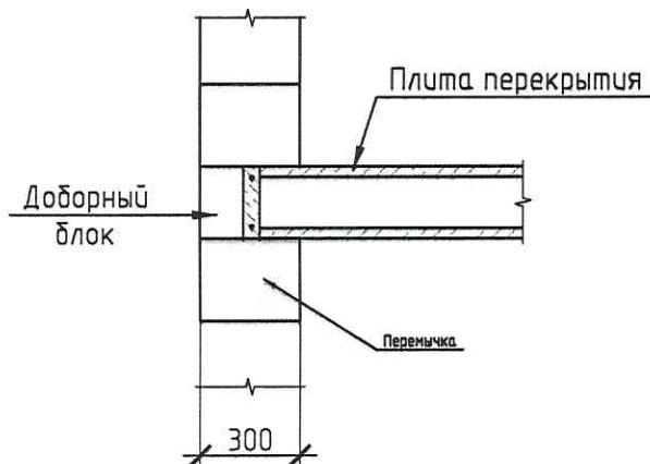
Для стен толщиной 375 мм
