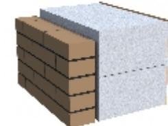
Облицовку можно возводить параллельно с возведением несущей стены, или осуществлять облицовочные работы на готовой стене. Для соединения кладки из газобетона и кирпича используются гибкие связи, которые закладываются в швы или монтируются в стену из газобетона. Данный вариант облицовки позволяет отказаться от дополнительного утепления. Лицевая кирпичная кладка связывается с основной кладкой несколькими способами (рис.34).
